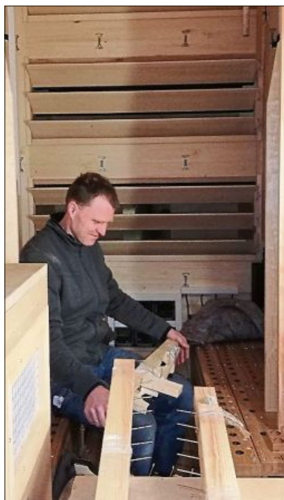
Ein Mitarbeiter der Firma Eule arbeitet im Fernwerk. Hinter ihm kann man gut die drehbaren Lamellen erkennen, mit denen der Orgelspieler die Lautstärke stufenlos regulieren kann. – Die ersten Pfeifen sind schon montiert. – So sieht der Kasten des Fernwerks bei geschlossener Tür aus.
